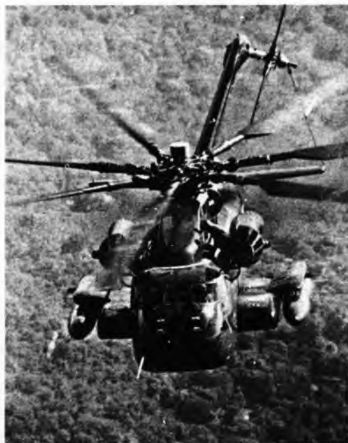
Sl. 5. Helikopter Sikorsky YCH-53E. Na slici je vidljiva promjena cikličnog koraka pojedinih lopatica rotora
